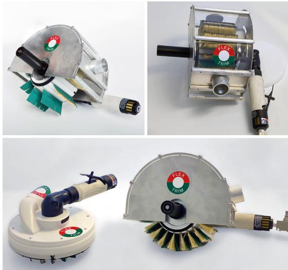
FlexSchleifer 50 ist ein von Flex Trim entwickelter Handschleifer, der eine echte Alternative zu herkömmlichen Handschleifgeräten der Industrie bietet. Er eignet sich zum Schleifen flacher und profilierter Werkstücke sowie für Werkstücke mit Kanten (Radius 5 – 10 mm). Die Drehzahl des pneumatisch betriebene FlexSchleifer 50 ist verstellbar. Das verlängert nicht nur die Lebensdauer der Schleifmedien, sondern führt auch zu einem besseren Schleifergebnis.
